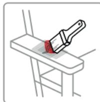
Appliquer 1 couche de Mat de Verre 300g/m<sup>2</sup> et imprégner de résine jusqu'à parfaite transparence du mat. Renouveler l'opération, mouillé sur mouillé, autant de fois que nécessaire.
